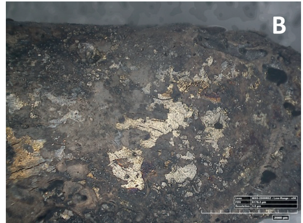
Afb. 3. Opnamen met de digitale microscoop. Een goudkleurige korst is zichtbaar op het oppervlak, B is een vergroting van A.
